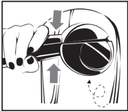
4. Anbring apparatet på det ønskede sted for krøllens start. Sørg for, at lokkens holdes lige ud og placeres midt i apparatet.
