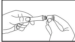
4. Conecte el extremo del tubo con el aparato de mano.
