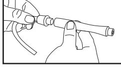
3. Coloque un filtro desechable en el extremo del tubo flexible.
