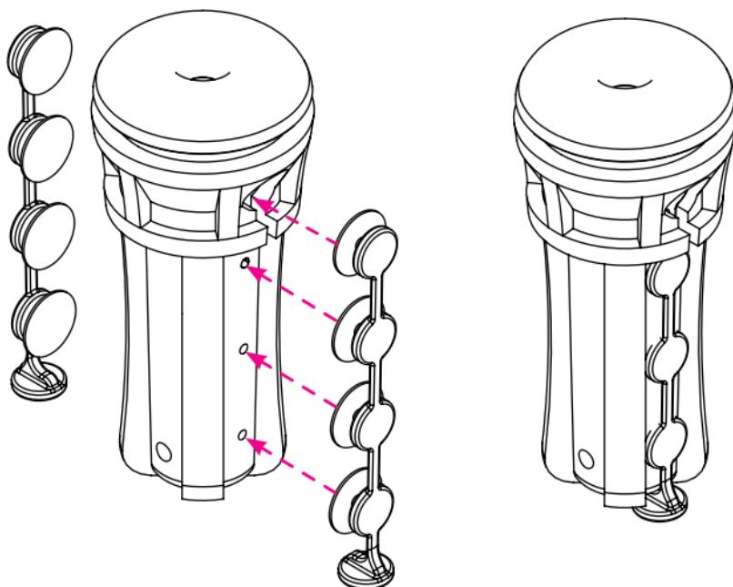
Jetzt musst du das vorbereitete Sleeve (2) mit dem dafür vorgesehenen Behälter (3) verbinden. Nehme den Behälter (3) und kontrolliere die Position der innenliegenden Magnete. Die Magnete deines vorbereiteten Sleeves (2) sollten vor dem Zusammenführen mit der Position der Magnete im Behälter übereinstimmen. Erfolgreich bist du dann, wenn 2 Mal ein deutliches „Klick“ zu hören ist.
