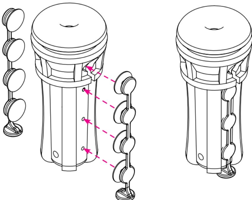
Теперь необходимо твой подготовленный рукав (2) соединить с предусмотренным держателем (3). Возьми держатель (3) и контролируй положение находящегося внутри магнита. Магниты твоего подготовленного рукава (2) должны совпасть с положением магнитов держателя перед соединением. Ты добьешься успеха в том случае, когда отчетливо будут слышны 2 «щелчка».
