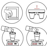
5b: Bland Resin art epoxy flaske A på 50g og Resin art epoxy flaske B på 25g i en papirkop (B2).
