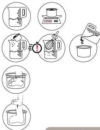
1a: Fyld målekoppen med 260 ml VARMT vand (ca. 24°C), og vej af 75 g. Alginate (formgivning) pulver i papirkoppen (B1).
