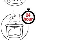
4f: Deixe a resina epóxi endurecer por pelo menos 24 horas antes de poder ser manuseada. (nota: a resina epóxi artística só endurece totalmente após 3-5 dias). (Temperatura mínima de processamento 20°C).
