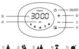
a) Indicateur de niveau de charge, b) Horloge et indicateur de la puissance de succion, c) Niveau inférieur, d) Niveau supérieur, e) Mode de marche
