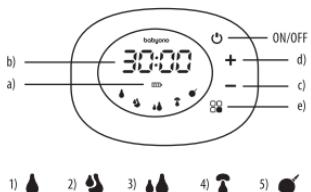
a) batterijniveau indicator, b) klok en zuigkrachtnivicator, c) laag niveau, d) hoog niveau, e) werkmodus
