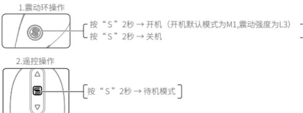
注：用遥控操作（震动环开启的状态）按2秒S键进入待机模式（30分钟无任何操作，震动环关机）
