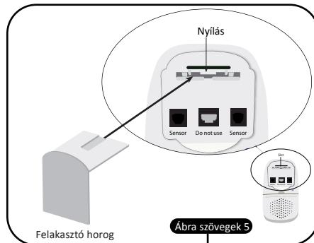
**5.** Erősítse a vezeték(ek) végén található csatlakozót(kat) a "SENSOR" jelölésű kimenetbe az Ellenőrző egység háttoldalán. (lásd az 5. és 6.ábrát). Amikor csak egy érzékelő padot használ, bármelyik "SENSOR" aljzatba csatlakoztathatja.
