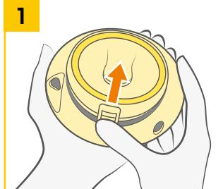
Otevřete kryt baterií na zadní straně posunutím ve směru šipky.
