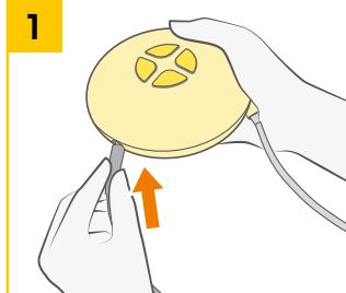
Připojte kabel síťového adaptéra k motoru.
