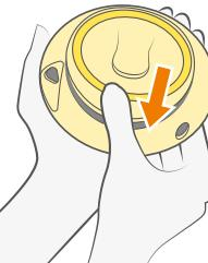
V případě typu Swing Flex vložte čtyři baterie typu AA Mignon LR6. V případě typu Swing Maxi Flex vložte šest baterií typu AAA Micro 1,5 V.
