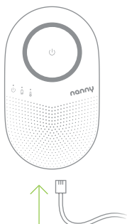
Rys. 9 Podłączanie przewodu tęczącego do modułu sterowania
