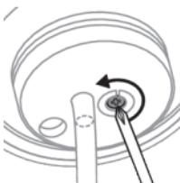
**10** Викрутіть гвинт за допомогою викрутки Philips.
