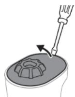
**4** Держите рукоятку за верхнюю часть одной рукой и снимите верхнюю крышку, приподняв ее отверткой с плоским шлицем.
