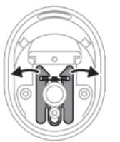
**8** Empurre o anel de retenção do bocal para dentro do dispositivo. O anel de retenção do bocal deve ficar completamente nivelado com o corpo.
