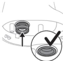
**8** 将喷嘴固定环推入设备。喷嘴固定环应与设备主体部位完全齐平。
