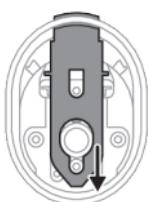
**6** Rimuovete il dispositivo di scorrimento del pulsante di rilascio del beccuccio.
