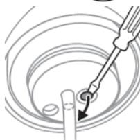
**9** 在手柄底部, 用平头螺丝刀撬开螺丝盖, 将其拆下。
