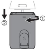
**3** Desprindeți rezervorul de pe mâner.
