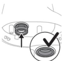
**8** Вставте кільце-фіксатор насадки в пристрій. Кільце-фіксатор насадки має встати врівень із корпусом.
