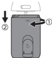
**4** Sujete la parte superior del mango con una mano y extraiga la cubierta superior haciendo palanca con un destornillador plano.
