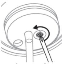
10 ถอนสกรูอุดด้วยไขควง Philips
