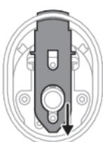
**6** Снимите ползунок кнопки фиксации насадки.
