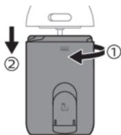
**4** Sapın üst kısmını tek elle tutun, üst kapağı çıkarmak için düz uçlu tornavidayla kaldırın.
