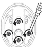
**6** Irrota suuttimen vapautuspainikkeen liukusäädin.
