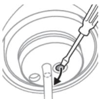
**9** Uklonite poklopac vijka na dnu drške tako što ćete ga odići odvijačem sa ravnom glavom.
