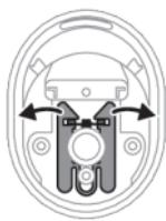
**8** Drücken Sie den Düsenaufnahmerring in das Gerät. Der Düsenaufnahmerring sollte vollständig mit dem Gehäuse gespült werden.
