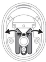
**8** Coloca el anillo de retención de la boquilla en el dispositivo. El anillo de retención de la boquilla debe quedar completamente insertado en el cuerpo.
