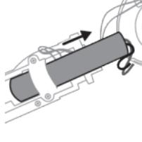
**13** 找到并切断直接连接电池的电线。
