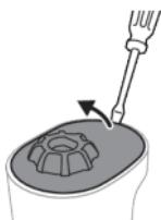
**5** Ubica y quita los 4 tornillos debajo de la cubierta superior con un destornillador Philips.
