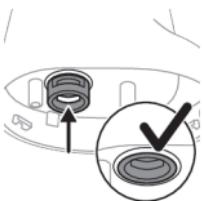
**8** Împingeți inelul de reținere a capului de curățare în dispozitiv. Inelul de reținere a capului de curățare trebuie complet la nivel cu corpul.
