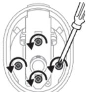
**5** Localizați și scoateți toate cele 4 șuruburi de sub capacul superior cu ajutorul unei șurubelnițe cu cap Phillips.
