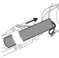
**14** Vysuňte baterii z držáku.
