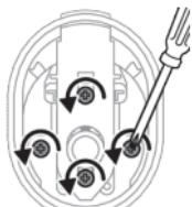
**5** Suraskite ir „Philips“ atsuktuvu išsukite visus 4 varžtus po viršutiniu dangteliu.
