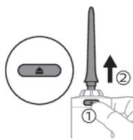
**2** Снимите и выбросьте насадку. Чтобы снять насадку, нажмите кнопку снятия насадки и снимите насадку с рукоятки.
