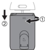
**4** Tenez le haut du manche d'une main et retirez le couvercle supérieur en faisant levier avec un tournevis à tête plate.
