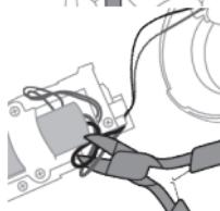
13 找到並切斷直接連接電池的電線。
