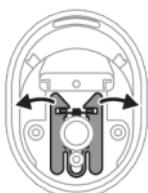
**8** Paina suuttimen kiinnitysrengas laitteeseen. Suuttimen kiinnitysrenkaan pitäisi olla kokonaan rungon tasossa.
