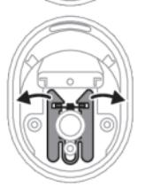
6 拆下喷嘴拆卸按钮滑块。
