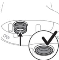
**8** Натиснете задържащия пръстен на накрайника в устройството. Задържащият пръстен на накрайника трябва да бъде подравнен напълно с корпуса.
