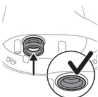
**8** Poussez la bague de rétention de la buse dans l'appareil. La bague de rétention de la buse doit être entièrement rentrée dans le corps de l'appareil.
