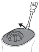
**4** Tineți partea superioară a mânerului cu o mână și scoateți capacul superior prin desprinderea acestuia cu ajutorul unei șurubelnițe cu cap plat.
