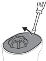
**4** Houd de bovenkant van het handvat met één hand vast en verwijder de bovenklep door deze met een platte schroevendraaier los te wrikken.
