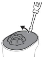
**4** Tenete la parte superiore del manico con una mano e rimuovete il coperchio superiore facendo leva con un cacciavite a testa piatta.
