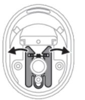
**8** Poussez la bague de rétention de la canule dans l'appareil. La bague de rétention de la canule doit être entièrement rentrée dans le corps de l'appareil.
