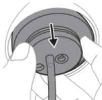
**11** Uchopte spodní kryt a vytáhněte vnitřní část zařízení z rukojeti.
