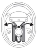
**8** Presione el anillo de retención de la boquilla para insertarlo en el dispositivo. El anillo de retención de la boquilla debe lavarse completamente con el cuerpo.
