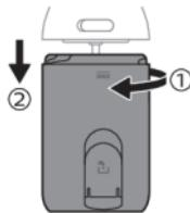
**4** Sostén la parte superior del mango con una mano y quita la cubierta superior haciendo palanca con un destornillador de punta plana.
