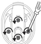
**5** Leta reda på och ta bort alla fyra skruvarna under det övre locket med en stjärnskruvmejsel.
