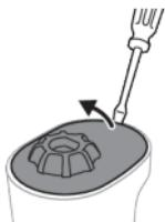
**4** Håll i toppen av handtaget med ena handen och ta bort det övre locket genom att bända loss det med en skruvmejsel.
