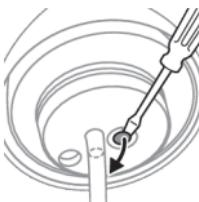
**9** За допомогою плоскої викрутки підніміть кришку з різьбою, розташовану в нижній частині ручки.
