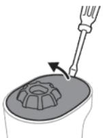
**5** Localice y quite los 4 tornillos debajo de la cubierta superior con un destornillador Philips.
