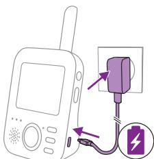
Uključite adapter napajanja u roditeljsku jedinicu, a adapter uključite u zidnu utičnicu.
