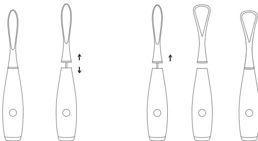
Чтобы заменить головку щетки, убедитесь, что ваша ISSA mini 2 выключена и потяните головку щетки прямо вверх до отсоединения. Когда щетинки сменной головки обращены вперед, выровняйте центральное отверстие с помощью металлического дюбеля и сильно нажмите, чтобы надежно прикрепить.
