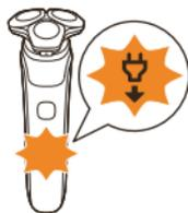
Das Symbol für "vor Gebrauch von der Stromversorgung trennen" blinkt, um Sie daran zu erinnern, das Gerät von der Steckdose zu trennen und den kleinen Stecker vom Gerät abzuziehen, bevor Sie es einschalten.
